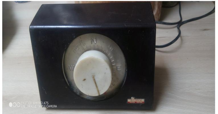
Les rotors STOLLE existent sous plusieurs versions. Une commande par 3 fils ou 4 fils. Parait-il qu'il existe des versions en 5 fils, mais je n'en ai pas croisé.
