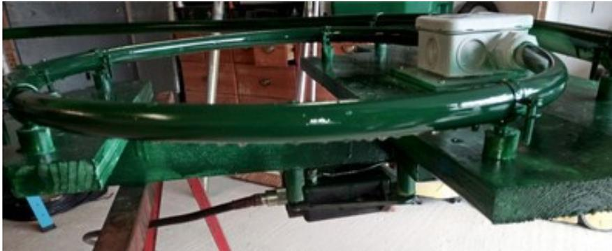
le boîtier de commande relié par un câble 8 fils à l'antenne ( j'ai intégré dans ce boîtier l'analyseur d'antenne type Rig Expert 0-150 Mhz)
