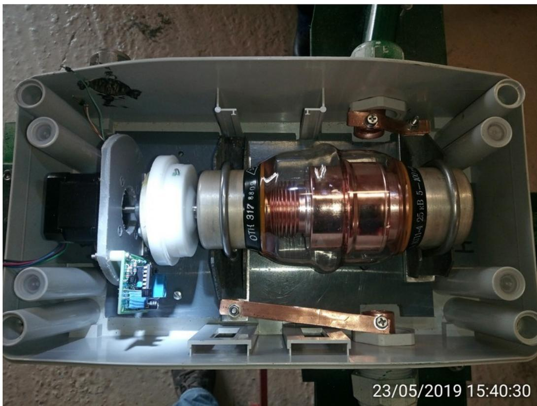
de gauche à droite : moteur pas à pas, support moteur PVC, carte de mesure de la température interne du boîtier, flector isolant TEFLON, CV sous vide ; le tout posé sur un support isolant lui même démontable et fixé dans le boîtier ; étanchéité absolue oblige... Raccordement à la grande boucle par deux bandes de cuivre home made.. passage des 2 extrémités du tube Cu de 22 par presse étoupe pro..
