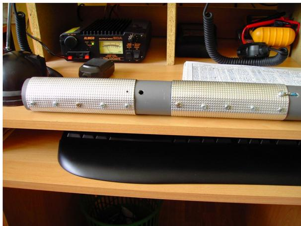
Les cylindres sont faits en feuilles d'aluminium vissées ou rivetées sur le tube de PVC gris (-sans carbone !!!-). Le fil électrique est du fil électrique standard de 2,5 mm<sup>2</sup>
