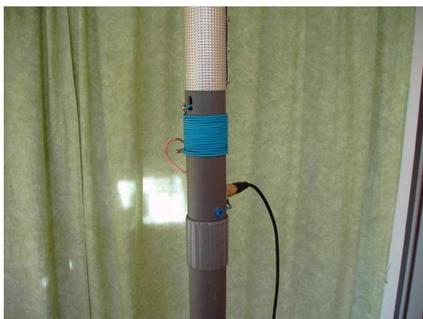
Il convient de signaler que le réglage est très pointu, et il conviendra de faire plusieurs essais, la meilleure solution étant, comme vous le verrez sur les photos, de dégager la gaine à certains endroits de la spire et de shunter avec une petite pince croco de façon à réduire artificiellement un peu la longueur de la spire.
